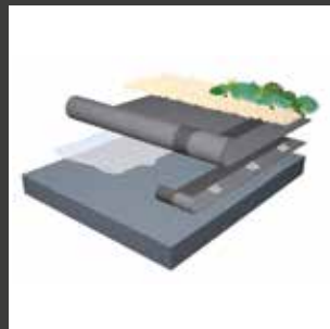
EPDM-Dachabdichtung und ext. Dachbegrünung
